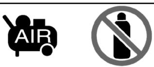
Como esta herramienta está diseñada y fabricada para operar usando la presión de aire que se genera por el compresor de aire autorizado por una organización de certificar la seguridad, no puede usar otro tipo de gas – gases combustibles como oxígeno y acetileno – menos este aire comprimido. Si no, causará no sólo una avería de la herramienta sino también una manipulación mala o una explosión haciendo daño fatal para el usuario o las personas cercanas.
